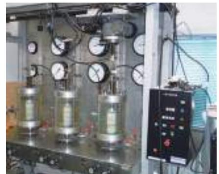
土質試験室(三連三軸圧縮試験機)
