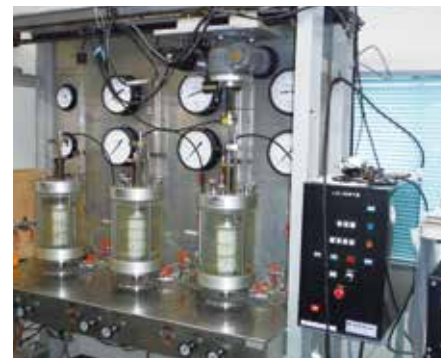
土質試験室(三連三軸圧縮試験機)
